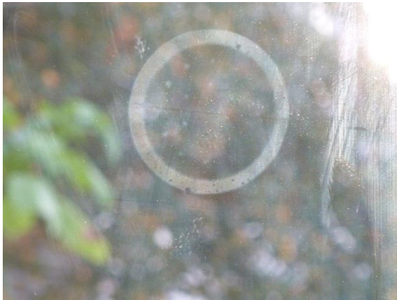
Aufgetrockneter Belag bei direkter Sonnenbestrahlung
